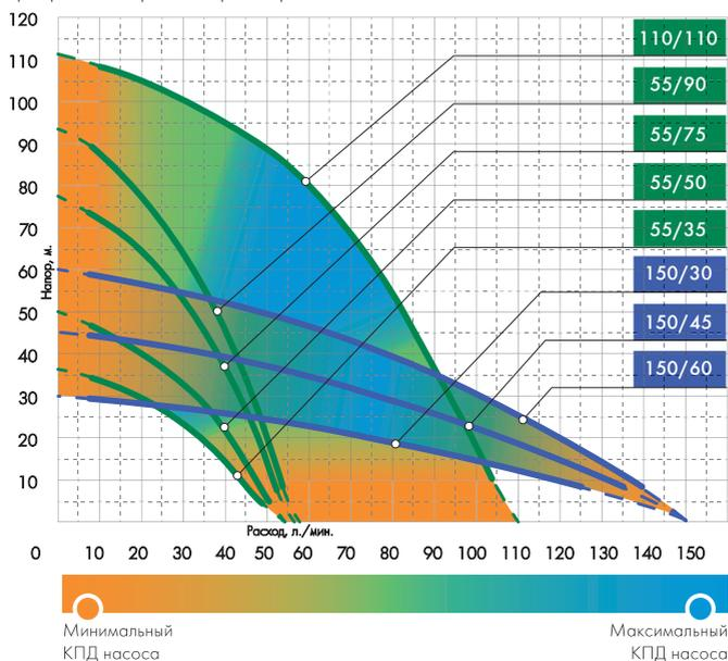
\* Заявленные характеристики насосов были получены при испытании с холодной чистой водой без газа и абразивных примесей, а также напорной магистралью согласно модели насоса и напряжением 220В.
